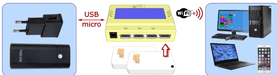
Obr. 2: Bloková schéma meracieho systému uLAB
